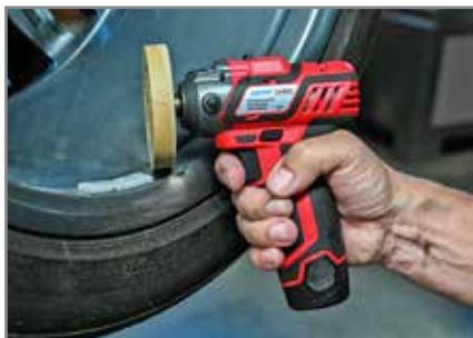
Zum Entfernen von Auswuchtklebstoff in Verbindung mit 7RS85.
