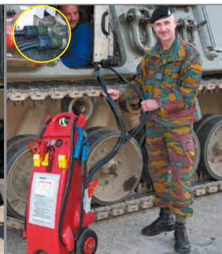
Startvorgang an einem Panzer mit Nato-Doppelstecker
