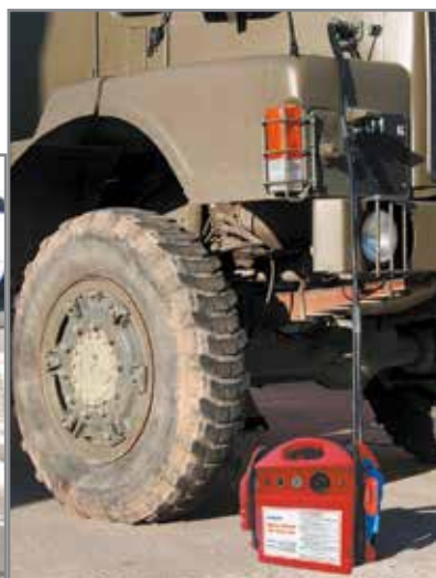
Startvorgang an einem Panzer mit Nato-Doppelstecker
